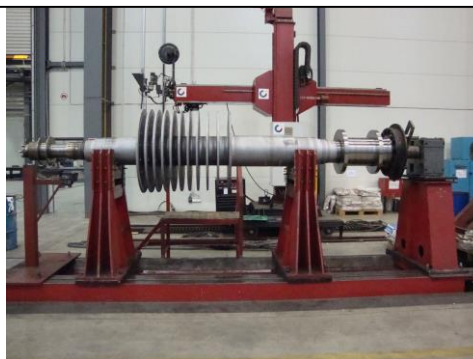
Zdj.11 Stanowisko do napawania wirników turbin
