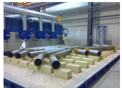
Zdj.5 Piec do obróbki cieplnej.
