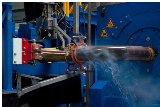
Zdj.8 Proces gięcia indukcyjnego łuku.
