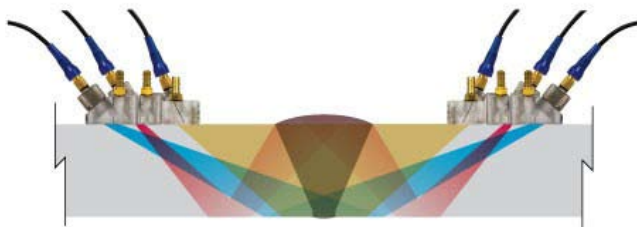
Rys. 23. Zestaw do badań PV100/Badania TOFD/UT
