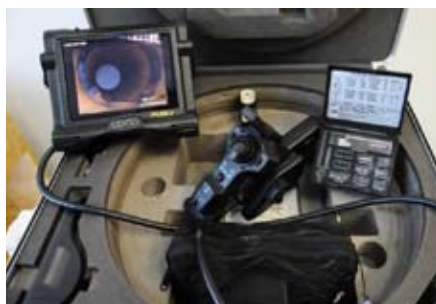
Rys. 7. Grubościomierze ultradźwiękowe oraz wideoendoskop
