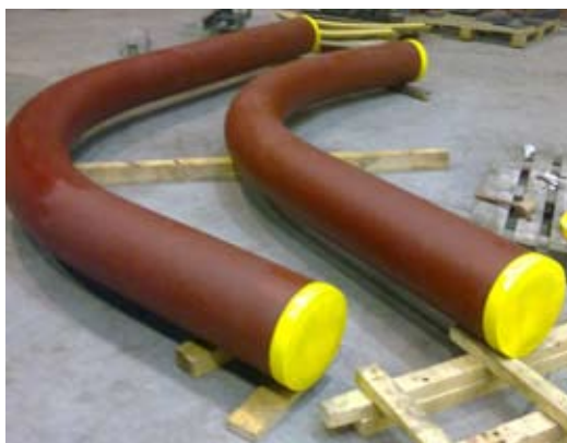
Rys. 5. Łuki Ø323,9x40 wykonane metodą gięcia indukcyjnego
