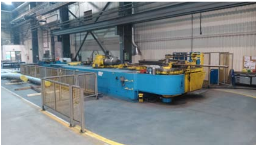
Rys. 2. Maszyna CNC 220HD do gięcia łuków metodą na zimno
