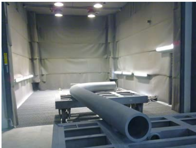
Rys. 8. Łuk Ø323,9x40 mm po czyszczeniu strumieniowo-ściernym w komorze śrutowniczej
