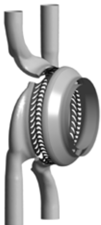
Rys. 12. Widok modelu obliczeniowego dla symulacji przepływowej, której celem było określenie parametrów pary za skrzynkami dyszowymi
