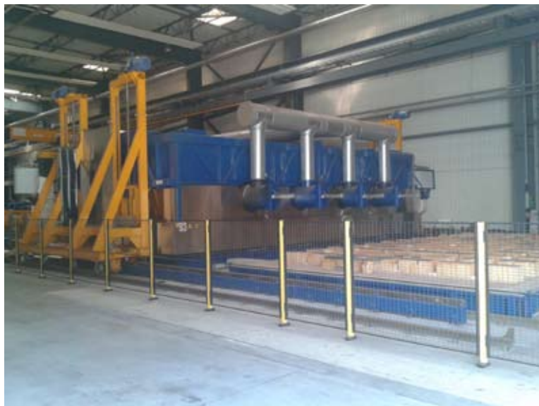
Rys. 6. Piec do obróbki cieplnej elementów
