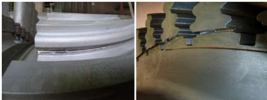
Rys. 4. Naprawa wad poprzez szlifowanie miejscowe
