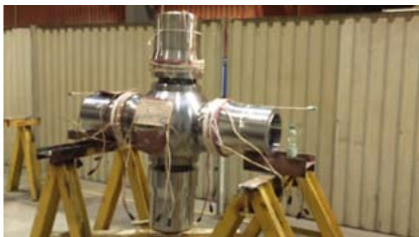
Rys. 10. Czwórnik 4 \times \varnothing 323,9 \times 40 mm – przygotowanie do spawania
