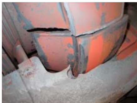
Rys. 2. Uszkodzony pierścień kierujący kąta regulacyjnego
