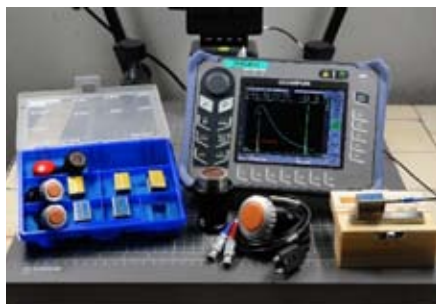
Rys. 6. Defektoskop Phased Array/TOFD oraz ultradźwiękowy
