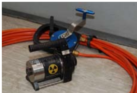
Rys. 5. Izotop SE 75 oraz lampa rentgenowska ERESCO
