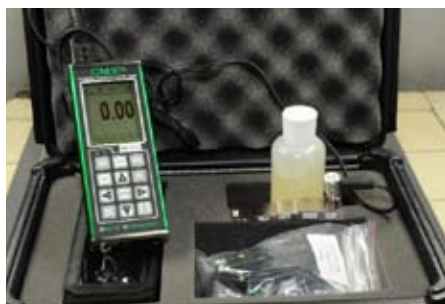
Rys. 7. Grubościomierze ultradźwiękowe oraz wideoendoskop
