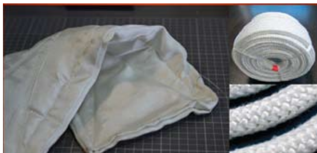
Rys. 17. Wyposażenie dodatkowe do badań RT w podwyższonych temperaturach – przekładka oraz sznurek termoizolacyjny
