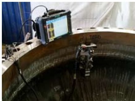
Rys. 20. Badania spoin podczas prefabrykacji przegrzewacza regeneracyjnego XW
