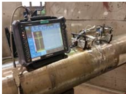
Rys. 20. Badania spoin podczas prefabrykacji przegrzewacza regeneracyjnego XW
