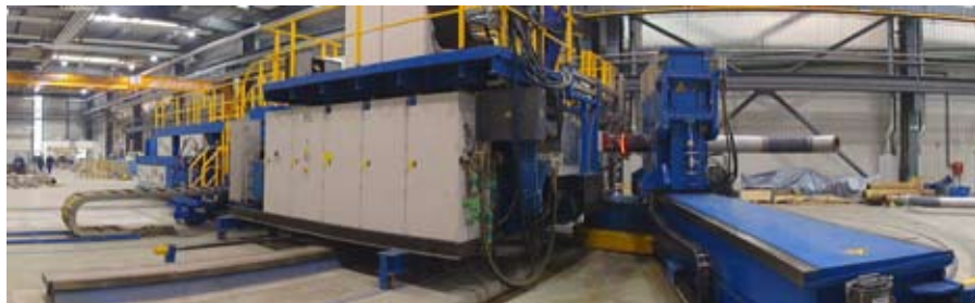
Rys. 4. Maszyna do gięcia indukcyjnego łuków rurowych
