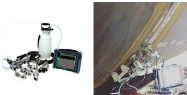
Rys. 22. Zestaw do badań/Badania TOFD/PA wieży wiatrowej
