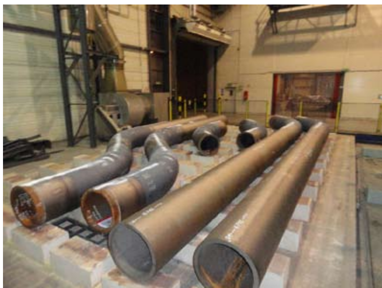
Rys. 7. Łuki gięte \varnothing 508 \times 20 mm przygotowane do obróbki cieplnej
