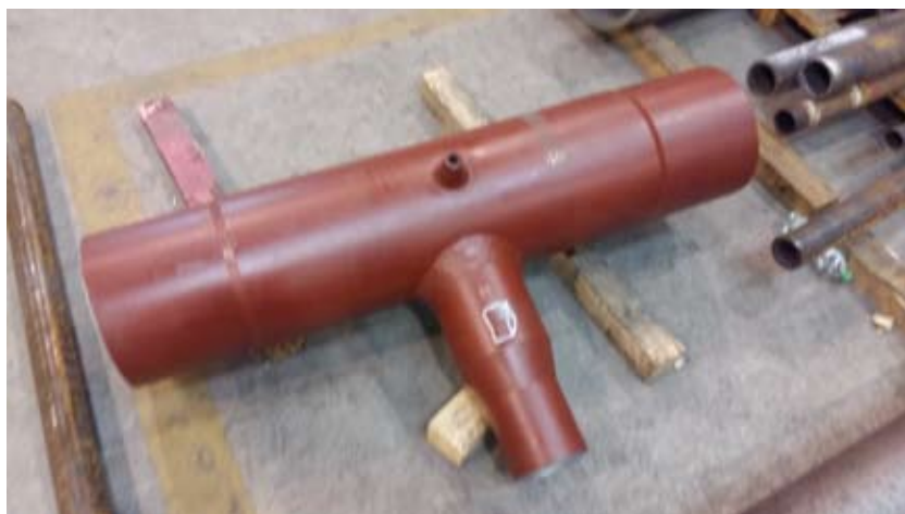
Rys. 12. Trójnik redukcyjny pary świeżej (323,9x40/159x17,5)
