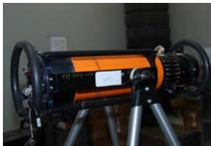
Rys. 5. Izotop SE 75 oraz lampa rentgenowska ERESCO
