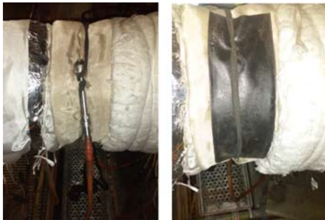
Rys. 19. Przeprowadzenie badań radiograficznych na przetopie (urządzenie gammamat SE-75)
