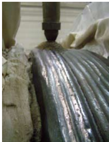
Rys. 6. Proces napawania tarcz wirnikowych
