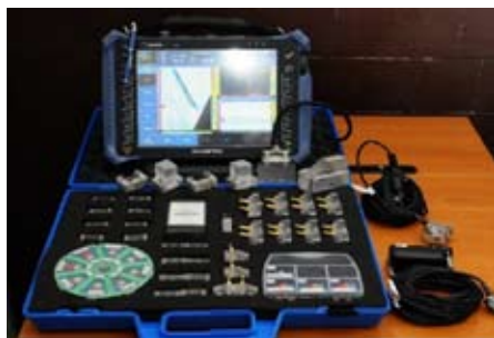
Rys. 6. Defektoskop Phased Array/TOFD oraz ultradźwiękowy
