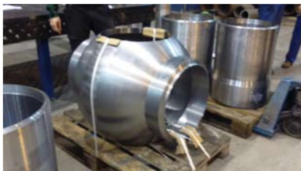
Rys. 9. Elementy składowe czwórnika 4 \times \varnothing 508 \times 20 mm
