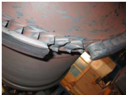
Rys. 4. Ubytek 3 łopatek kąta regulacyjnego
