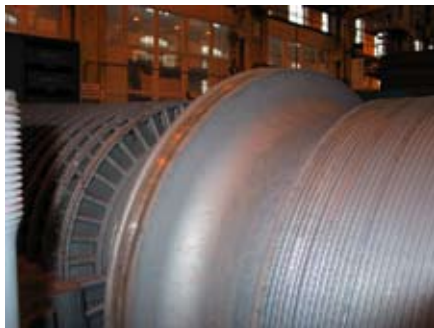
Rys. 6. „Stoczone” topatki kąta regulacyjnego
