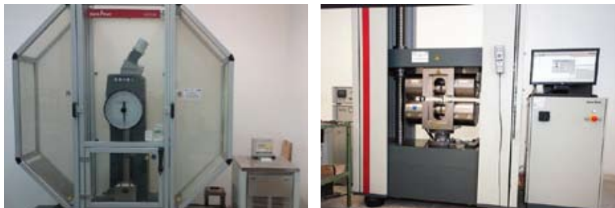
Rys. 7. Charpy'ego oraz maszyna wytrzymałościowa
