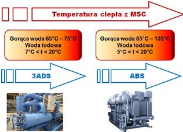
Rys. 13. Podział technologii sorpcyjnego wytwarzania chłodu ze względu na dostępny parametr [15]
