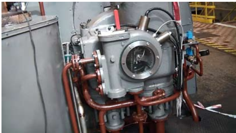
Rys. 3. Turbina PB8/4 po modernizacji
